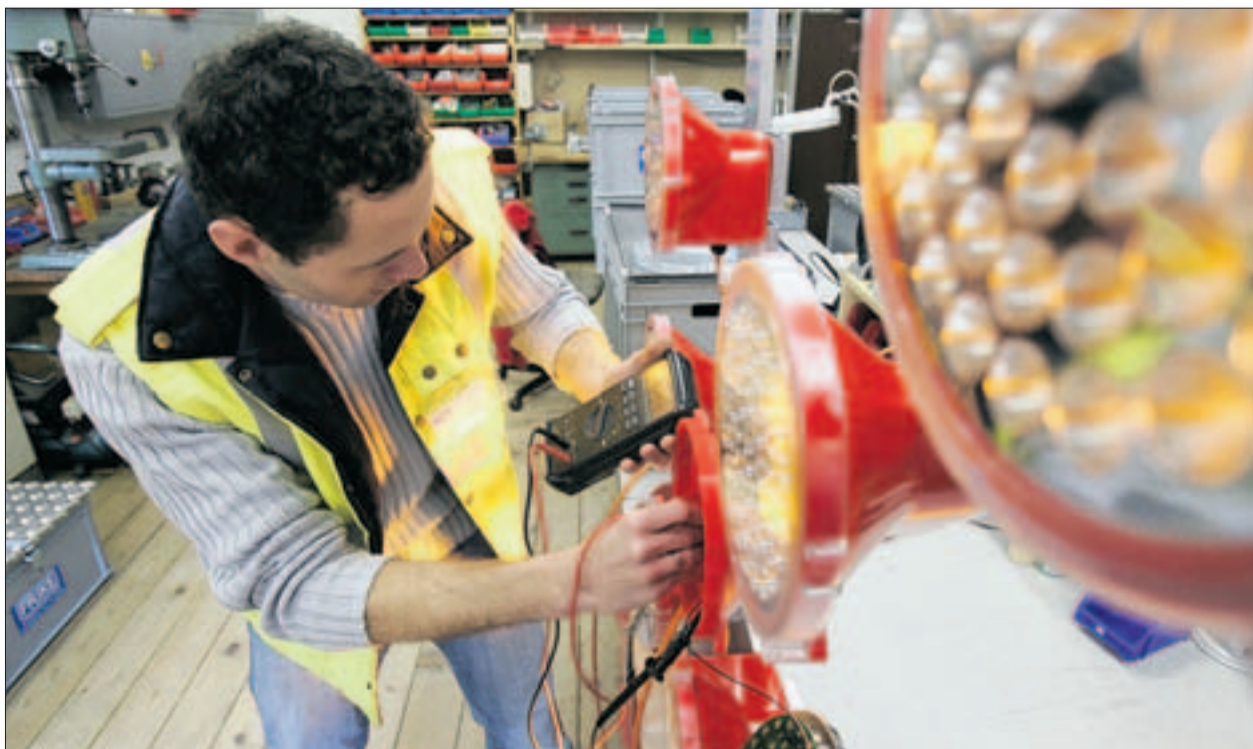
Mitarbeiter Marco Nägeli bei der Fehleranalyse und Justierung der LED-Leuchtpfeilsteuerung.
