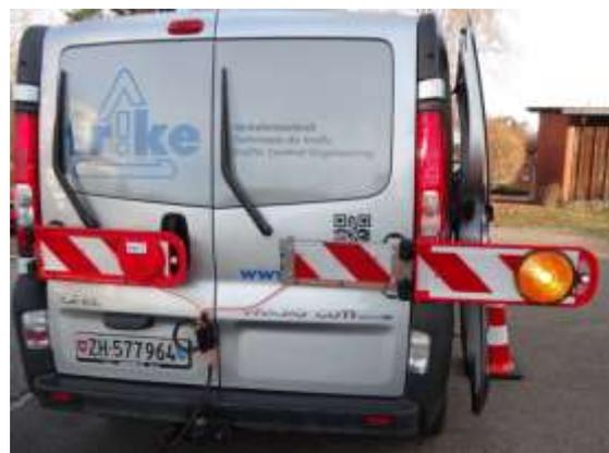
Das von FRIKE entwickelte Absicherungselement wird für die Signalisation des seitlich verbreiterten Fahrzeugprofils eingesetzt.
